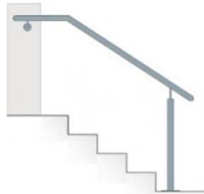
Treppenhandlauf Edelstahl mit Stift seitliche Wand-Treppe
